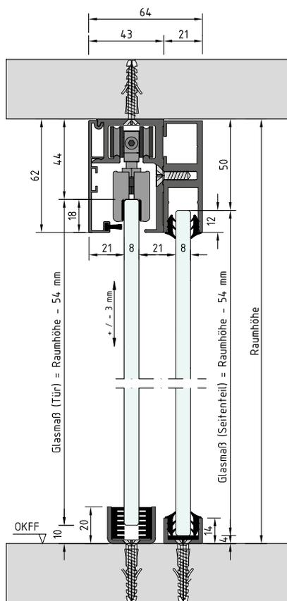
Montage mit Ganzglastür und feststehendem Seitenteil
