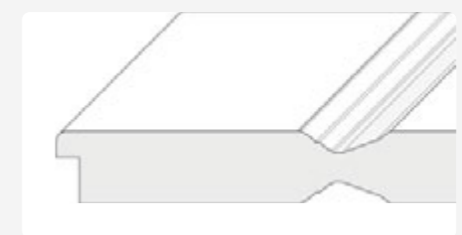
Türblatt mit innen liegenden Hohlprofilen, Einlage aus Röhrenspanplatten
