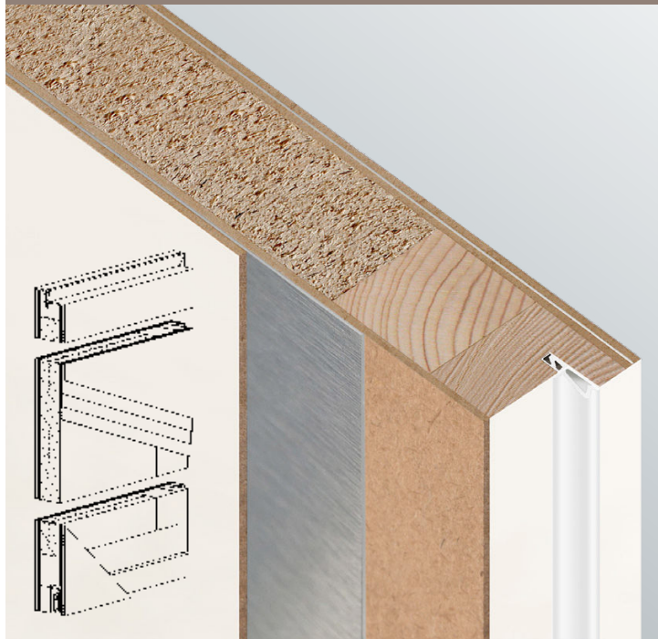
Türblattaufbau mit Aluminiumverbundabsperung
