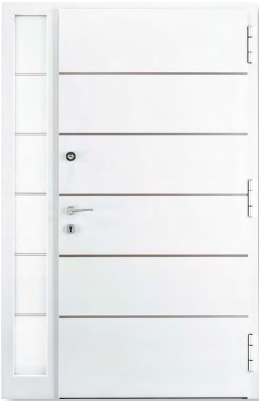
Mögliche Innenansicht mit Flügelüberdeckung. Profil mit Aufschlagdichtung, Rollentürbänder, Edelstahleinlagen flächenbündig
